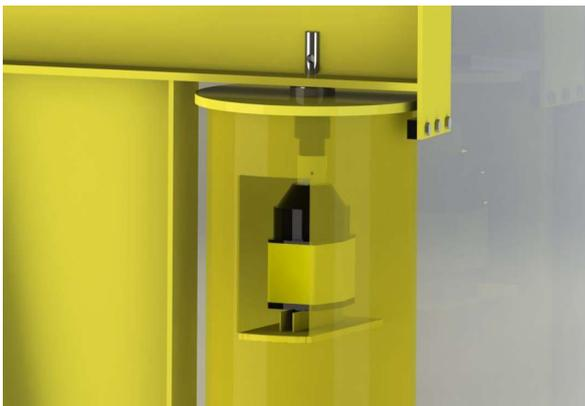
Le collecteur électrique 10A/30° est un dispositif électromagnétique pour les circuits de commande et/ou de commutation de commande à basse tension, à utiliser comme équipement électrique de machines (EN 60204-1) en conformité, selon la directive basse tension 2006/95/CE et la directive machines 2006/42/CE.
