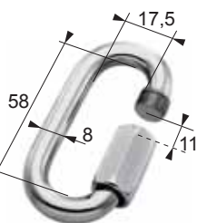
CMU : 700 kg Acier zingué Coef. sécu. 1/5 Poids : 0,078 kg
