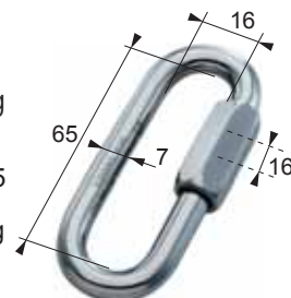
CMU : 500 kg Acier zingué Coef. sécu. 1/5 Poids : 0,062 kg
