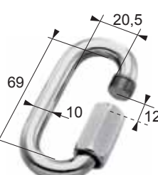
CMU : 1100 kg Acier zingué Coef. sécu. 1/5 Poids : 0,14 kg
