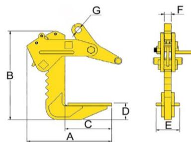
L'angle de tête d'élingage ne doit pas être supérieur à 90° ! Ne jamais lever plus d'une tôle ou d'un paquet de tôles cerclées à la fois !
